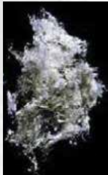
amosite (brown asbestos)
